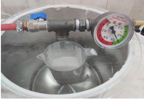
Şekil 4. Alçı karışımının vakum tankı içerisinde hava kabarcıklarının azaltılma işlemi.
