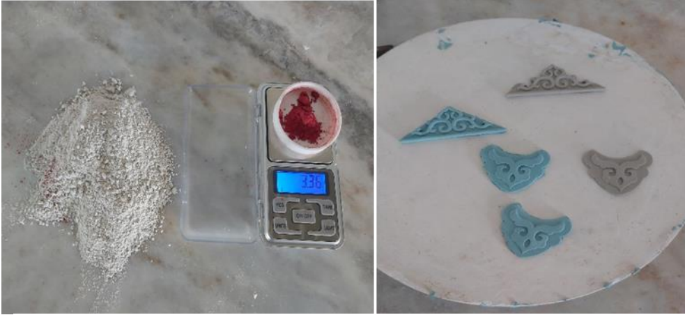
Şekil 10. Seramik malzemenin hazırlanışı ve baskı yapılmış hali.
