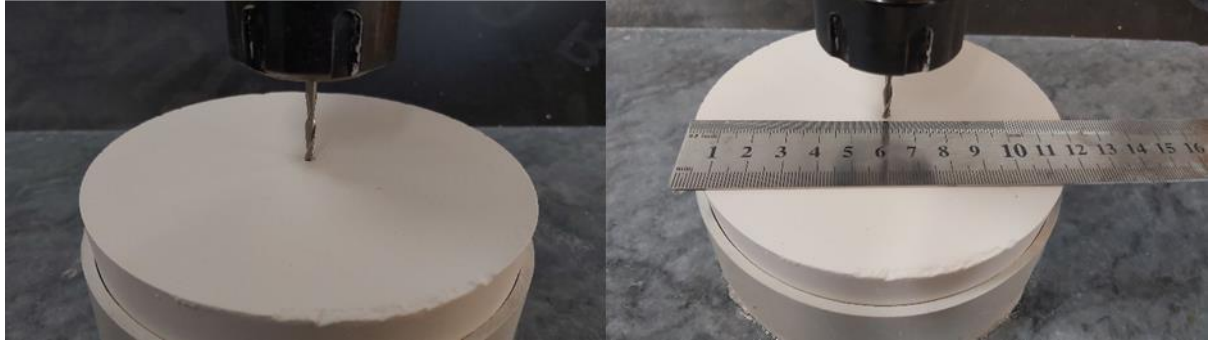
Şekil 8. CNC router makinesine alçı kalıpların sıfırlama işlemi.
