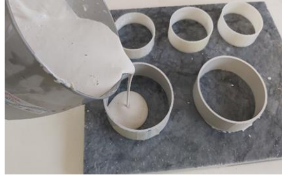
řekil 5. Vakumlu alçının kalıplara aktarılma iřlemi
