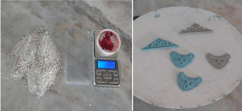
Şekil 10. Seramik malzemenin hazırlanışı ve baskı yapılmış hali.
