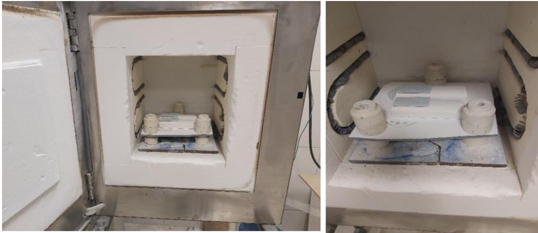
Şekil 11. Seramik malzemenin fırında pişirim aşaması.
