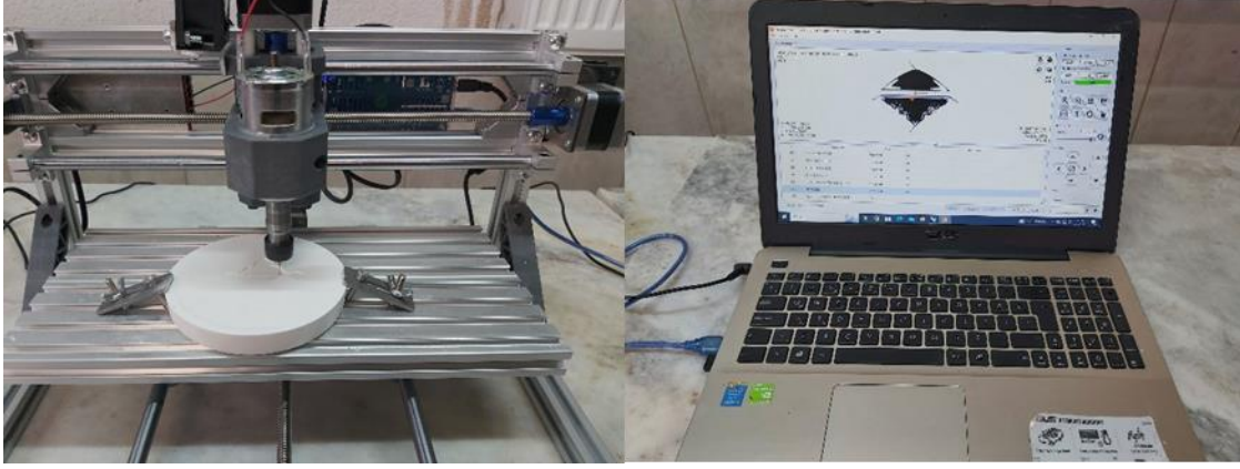
Şekil 9. CNC router ile alçı kalıbın işlenmesi.
